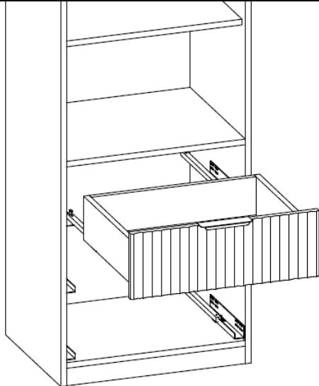
1. При установке ящика скобы выдвижных механизмов введите в отверстия на задней стенке ящика.
